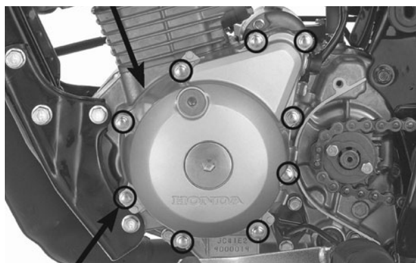
PARAFUSOS DA TAMPA FIAÇÃO DO INTERRUPTOR DE PONTO-MORTO
