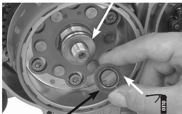
CONTRAPORCA FIXADOR DE VOLANTE DO MOTOR
